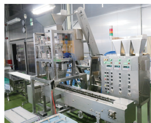
しらす自動供給機
