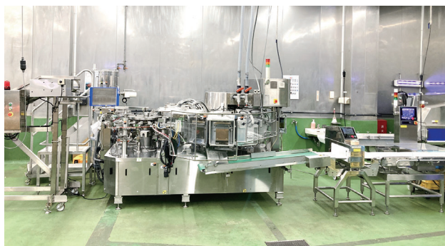
液充填、異物・重量確認作業が自動のできる自動包装ライン
