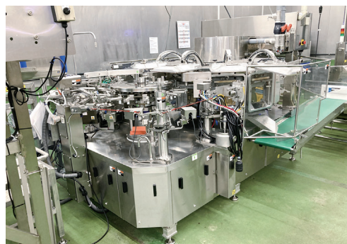
自動真空包装機（自動包装ラインの一部）
