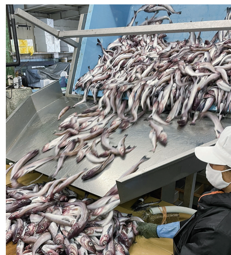
タンク回転機。フォークリフトでタンクを運び載せるだけで、タンクごと反転させて次の行程へと原料を運べる
