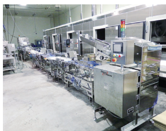
イクラ等原料充填・ 検査機器自動ライン
