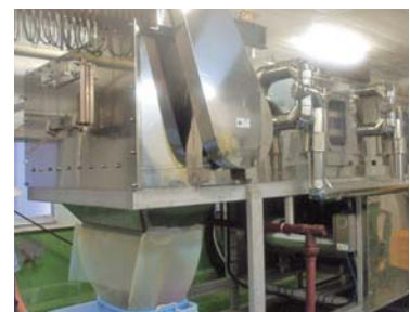
導入したメガスチーマー
