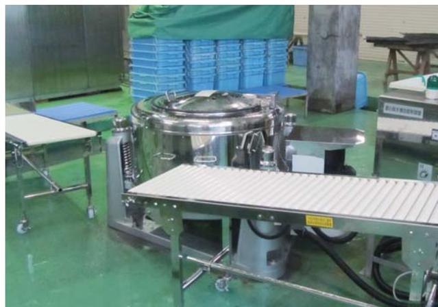
脱水機と乾燥機の間にもローラーコンベアを導入
