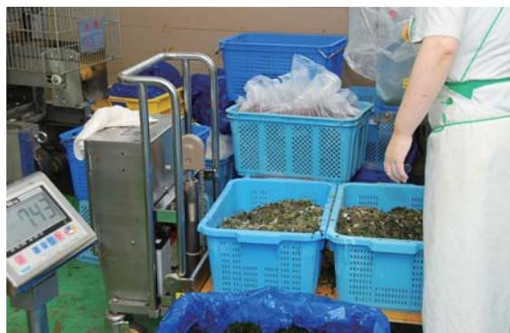
作業しやすい高さまでコンテナを持ち上げるための昇降機
