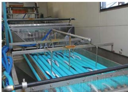
ローラーとローラーの隙間から小さい魚が落ちて選別される（ローラー選別機）
