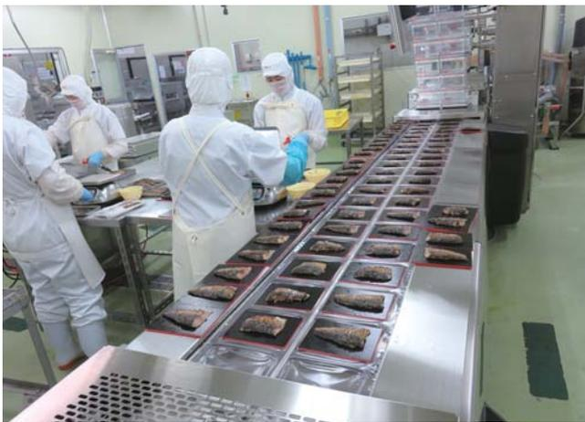
個食トレイパック製品の生産性を上げるために導入した全自動深絞り真空包装機一式
