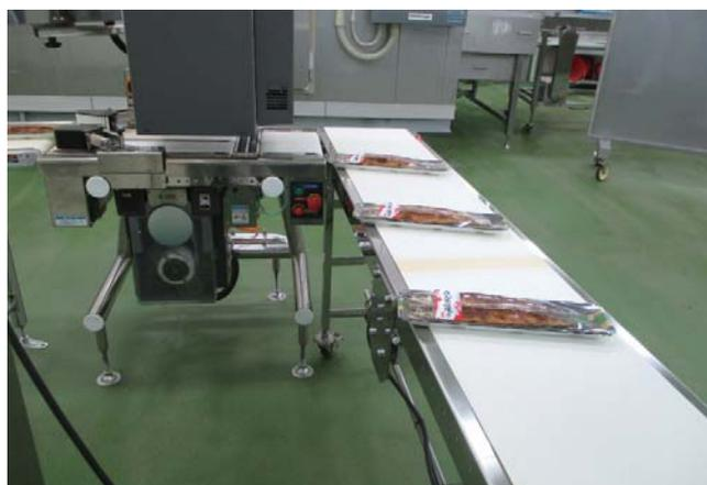
熱収縮するプラスチックフィルムにより密封包装するシュリンク包装ライン
