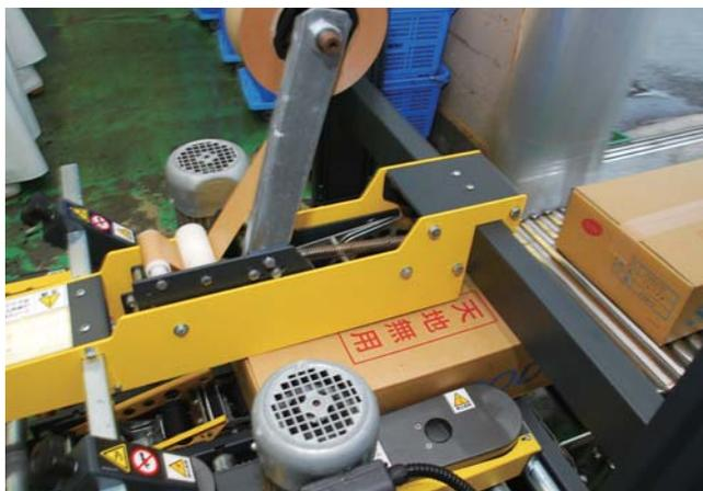
運搬用パレットから封函機までの間にローラーコンベアを導入
