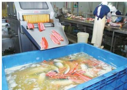
原料のサイズに合わせた濃度の塩水に24時間漬け込む
