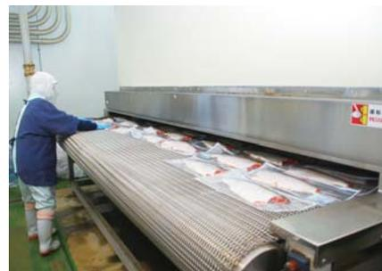
大型トンネルフリーザーによる急速冷凍で鮮度を保つ
