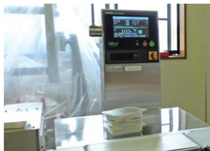
定額自動値付けラベラー（左）と金属探知機付きオートチェッカー。導入前は手作業で値付けシールをつけ、目視でチェックしていたため、大幅に作業効率が上がった
