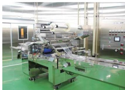
個食パックの包装に対応する横型ピロー包装機
