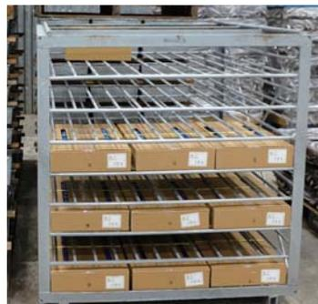
段ボール間の通風を確保し、冷凍効率を高める冷凍棚
