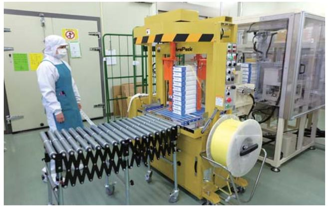
導入した段積み十字掛け梱包ライン一式。箱の大きさに応じて何段重ねるかを設定すれば、包装し、自動で積み重ね十字に結束するところまでを1ラインで行える
