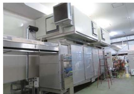
外気に全く触れない強制冷却放冷機によって、以前より衛生的な環境が確保できた
