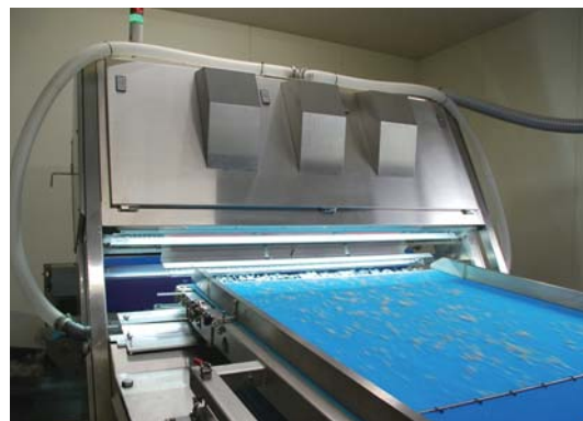
新しく導入した異物を除く色彩選別機
