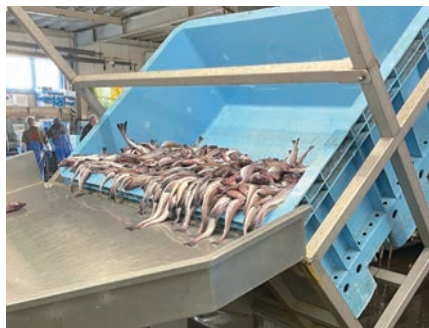
タンク回転機。フォークリフトでタンクを運び載せるだけで、タンクごと反転させて次の行程へと原料を運べる
