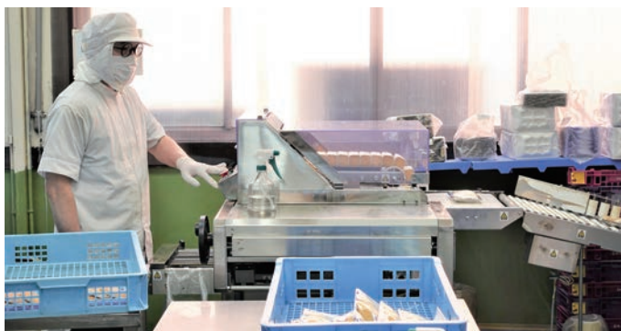
ストレッチフィルム包装機は、導入した初日から作業効率・不良品削減の成果が出た
