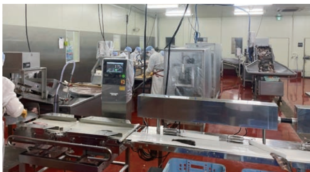
新機材で自動化された一次処理加工ライン
