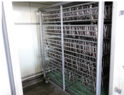
冷風乾燥機。乾燥時間が短縮され、その分生産量も増加した
