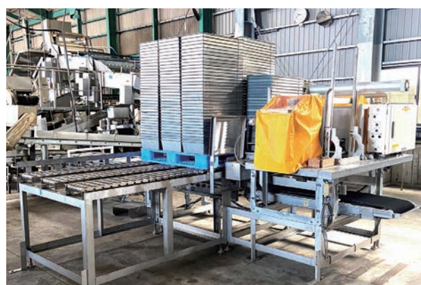
自動空パン器。しっかりとした爪で1枚、3.5kgのパンを押さえつつ、1枚ずつ供給する
