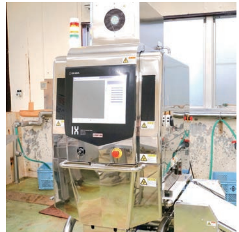
瞬時に異物を検知するX線検査装置
