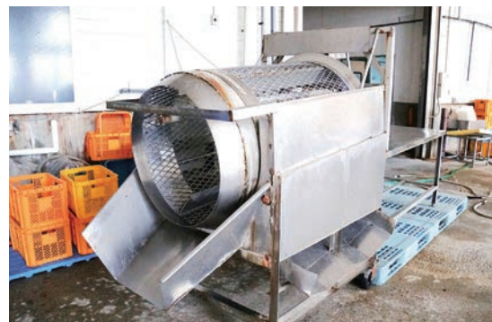
異物除去に現在使用しているドラム型回転機。 これに加え高圧洗浄機を導入予定
