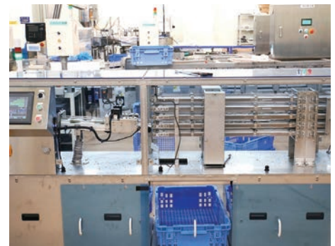
パック5段重ねまで対応できる段積装置
