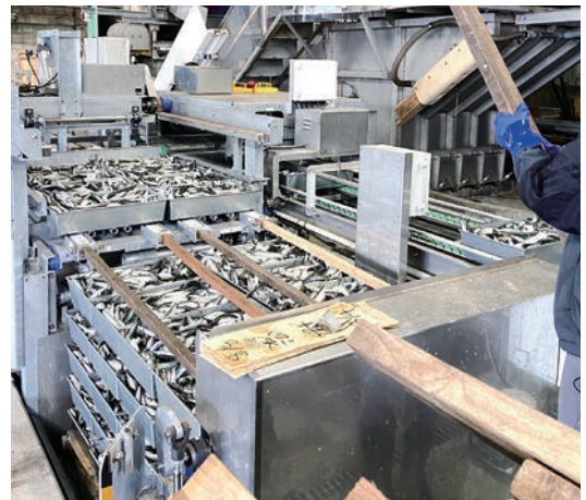
自動生積機。下にパレットが下がっていくため定位置で作業ができるように。パレットが崩れラインがストップすることもなくなった
