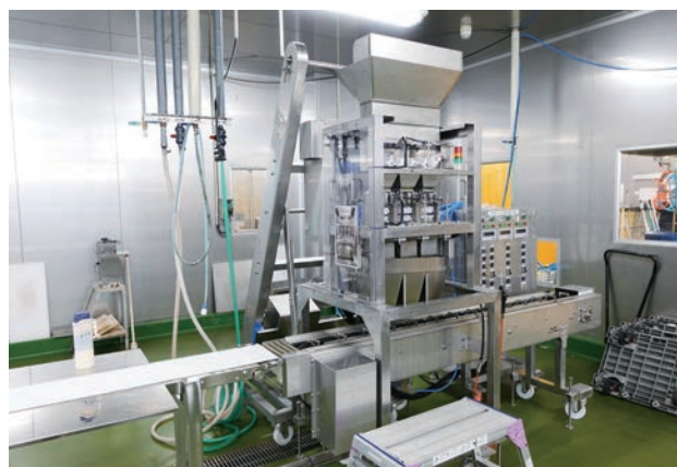
しらす自動供給機
