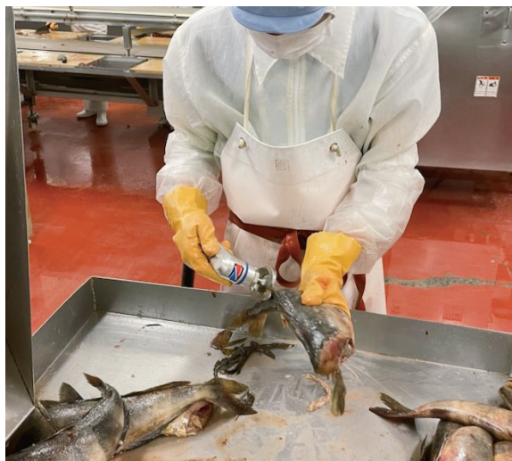
エア式ヒレ切断機の導入でヒレ取り作業の負担が軽減
