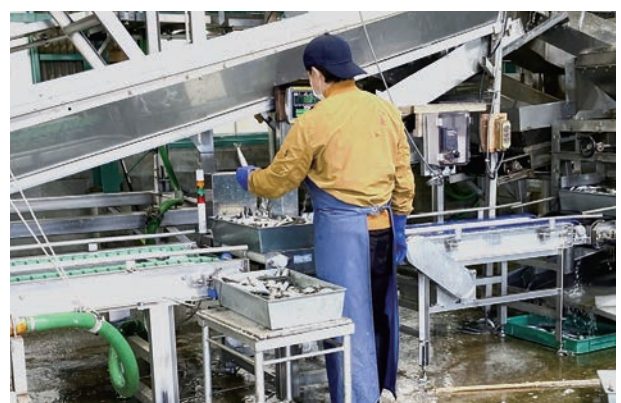
自動生積機再計量コンベア。赤、緑、黄色のランプが点いて重量不足などが一目でわかる
