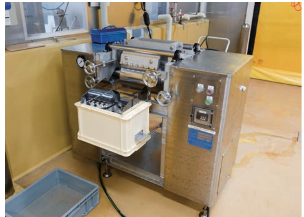
新商品の開発に役立つドラム式の乾燥機
