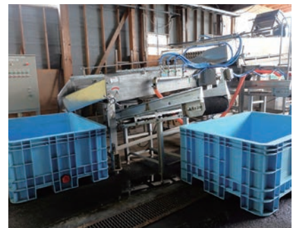
自動選別機ライン。従来は手作業で行っていたイワシの選別に主に使用し、大幅な作業時間短縮と増産が可能になった
