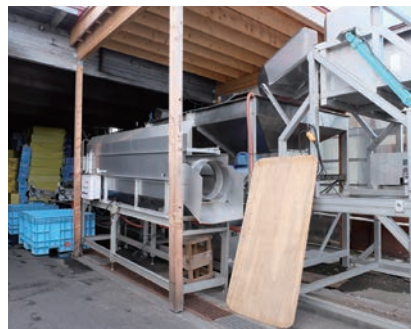
自動選別機ライン。従来は手作業で行っていたイワシの選別に主に使用し、大幅な作業時間短縮と増産が可能になった
